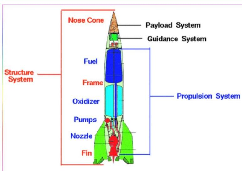
Здесь ты можешь увидеть упрощенные компоненты жидкотопливной ракеты. Где топливом является жидкий водород под давлением, а окислителем - жидкий кислород.
