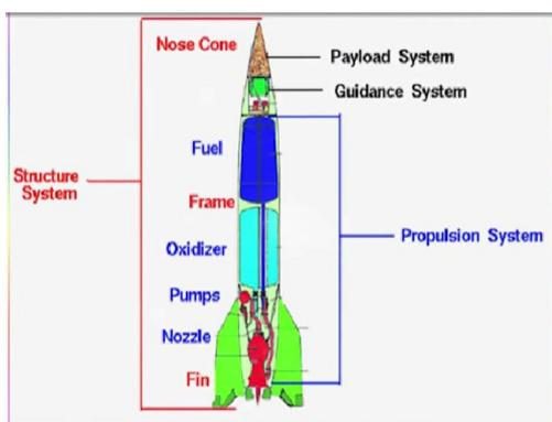
Qui puoi vedere i componenti semplificati di un razzo a combustibile liquido. Dove il carburante (Fuel) è l'Idrogeno liquido a pressione e, l'Ossidante (Oxidizer), è l'Ossigeno liquido.
