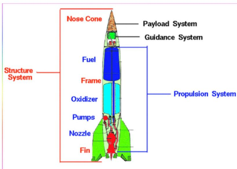
Vous pouvez voir ici les composants simplifiés d'une fusée à combustible liquide. Le combustible est l'hydrogène liquide sous pression et l'oxydant est l'oxygène liquide.
